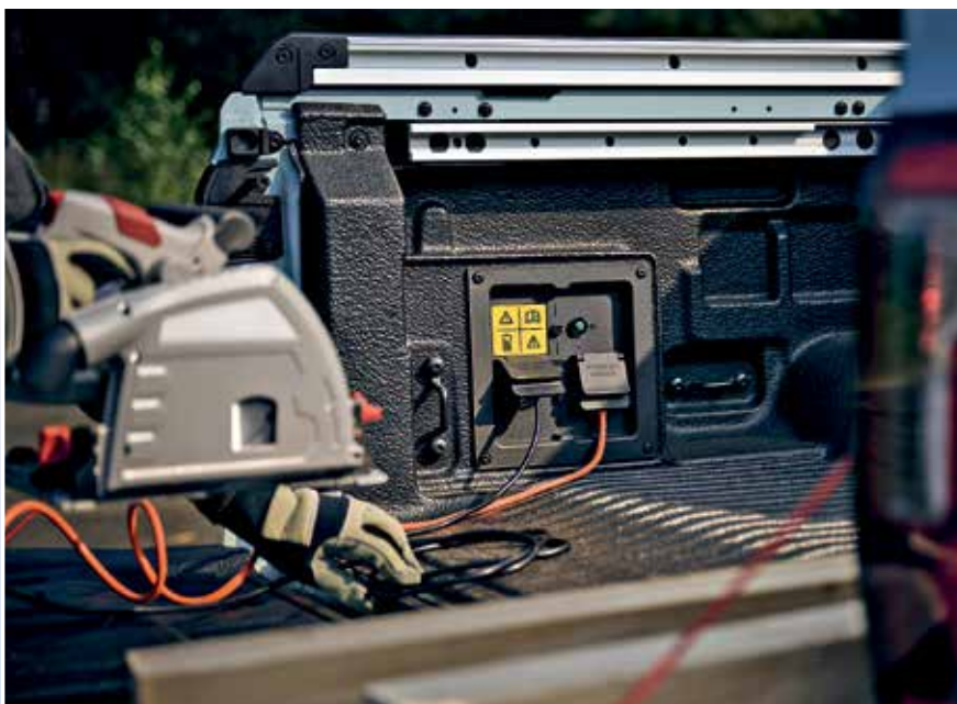
Η καρότσα έχει δυνατότητα παροχής ρεύματος 220 Volt για να συνδεθούν εξωτερικά χρήσιμα εργαλεία και εξοπλισμός.
