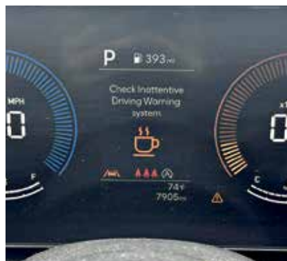
To Advanced Driver Distraction Warning (ADDW) είναι ένα σύστημα που ανιχνεύει την απόσπαση προσοχής του οδηγού (π.χ. λόγω χρήσης κινητού) και προειδοποιεί πριν... αναλάβει να σταματήσει το όχημα.
