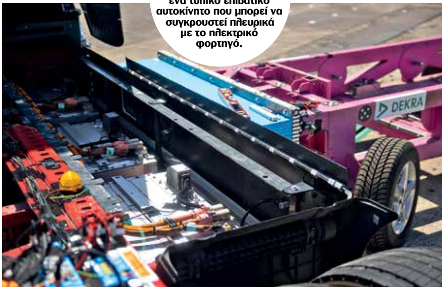
Η παραμόρφωση της πλευρικής προστατευτικής δομής είναι μικρή μετά από τη δοκιμή πλευρικής πρόσκρουσης με ένα όχημα βάρους άνω του ενός τόνου με ταχύτητα άνω των 50 χ.α.ώ.
