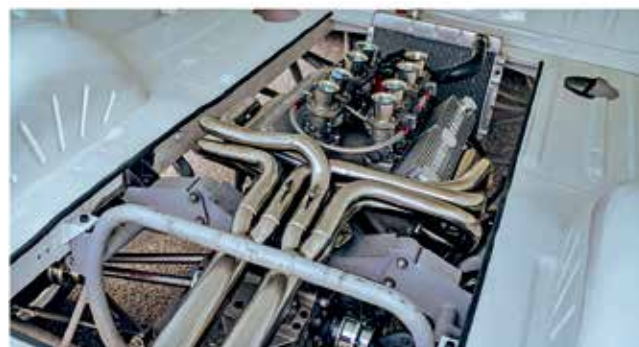
ΠΑΝΩ: Το Supervan κατασκευάστηκε πάνω σε ένα τροποποιημένο σασί Cooper Monaco spaceframe. ΑΡΙΣΤΕΡΑ ΠΑΝΩ: Η καμπίνα του δεξιότιμου Transit (έτσι οδηγούν στο «νησί») δεν έχει μονώσεις. Ο οδηγός κάθεται σε αγωνιστικό κάθισμα εποχής και ο μοχλός ταχυτήτων «κουμπώνει» στο δεξί του χέρι. ΑΡΙΣΤΕΡΑ: Εξωτερικά, το φορτηγάκι έμοιαζε πολύ με ένα τυπικό Transit, με εξαίρεση τους φαρδύτερους θόλους των τροχών και τα ειδικά ελαστικά. Οι πιο παρατηρητικοί διακρίνουν και το σωληνωτό πηλαιο, κάτω από το αμάξωμα.
