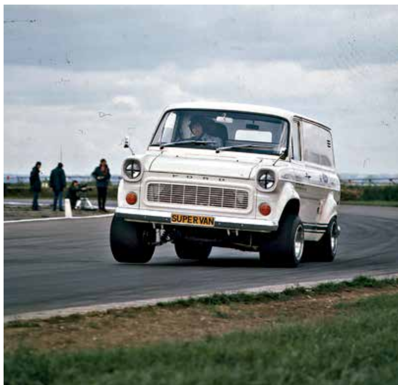
ΠΑΝΩ: Το Supervan κατασκευάστηκε πάνω σε ένα τροποποιημένο σασί Cooper Monaco spaceframe. ΑΡΙΣΤΕΡΑ ΠΑΝΩ: Η καμπίνα του δεξιότιμου Transit (έτσι οδηγούν στο «νησί») δεν έχει μονώσεις. Ο οδηγός κάθεται σε αγωνιστικό κάθισμα εποχής και ο μοχλός ταχυτήτων «κουμπώνει» στο δεξί του χέρι. ΑΡΙΣΤΕΡΑ: Εξωτερικά, το φορτηγάκι έμοιαζε πολύ με ένα τυπικό Transit, με εξαίρεση τους φαρδύτερους θόλους των τροχών και τα ειδικά ελαστικά. Οι πιο παρατηρητικοί διακρίνουν και το σωληνωτό πηλαιο, κάτω από το αμάξωμα.
