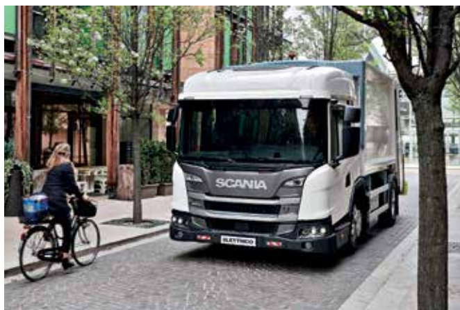
ΑΡΙΣΤΕΡΑ: Η νέα σειρά φορτηγών της Scania για δημοτικές επιχειρήσεις προσαρμόζεται σε κάθε είδους επιλογές γραμμής κίνησης, από τους παραδοσιακούς πετρελαιοκινητήρες και τους κινητήρες που καίνε βιοαέριο (HVO) μέχρι λύσεις με ηλεκτροκίνηση, σε διάφορες εκδόσεις ισχύος και αυτονομίας. ΔΕΞΙΑ: Scania L 280 B6x2*4, με αμάξωμα της FAUN για αποκομιδή απορριμμάτων και με δύο δεξαμενές για συμπιεσμένο φυσικό αέριο.
