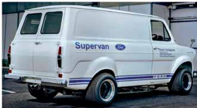
ΠΑΝΩ: Το Supervan κατασκευάστηκε πάνω σε ένα τροποποιημένο σασί Cooper Monaco spaceframe. ΑΡΙΣΤΕΡΑ ΠΑΝΩ: Η καμπίνα του δεξιότιμου Transit (έτσι οδηγούν στο «νησί») δεν έχει μονώσεις. Ο οδηγός κάθεται σε αγωνιστικό κάθισμα εποχής και ο μοχλός ταχυτήτων «κουμπώνει» στο δεξί του χέρι. ΑΡΙΣΤΕΡΑ: Εξωτερικά, το φορτηγάκι έμοιαζε πολύ με ένα τυπικό Transit, με εξαίρεση τους φαρδύτερους θόλους των τροχών και τα ειδικά ελαστικά. Οι πιο παρατηρητικοί διακρίνουν και το σωληνωτό πηλαιο, κάτω από το αμάξωμα.
