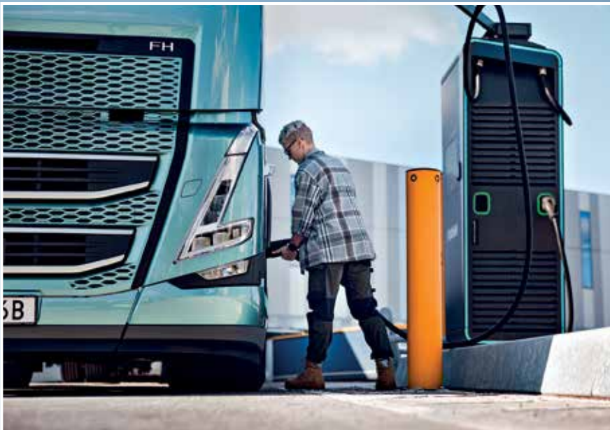
Το νέο Volvo FH Aero Electric μπορεί να αξιοποιήσει πλήρως τους νέους ισχυρούς φορτιστές 700-MCS (Megawatt Charging System), για τη φόρτιση των 8 μπαταριών του από το 20% στο 80% σε περίπου 50 λεπτά.
